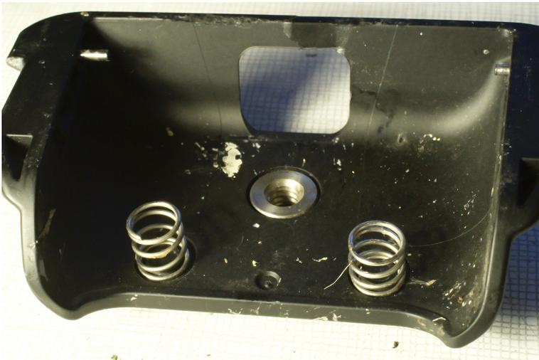
Remettre le module dans le support, puis bien enfoncer les axes avec un chasse goupilles
